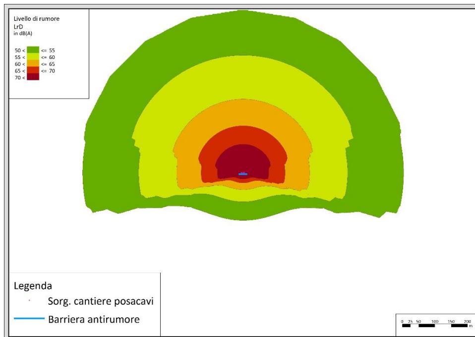
Figura 12: Mappa delle immissioni acustiche del cantiere lungolinea per la modifica della viabilità di cantiere in presenza di barriere antirumore
