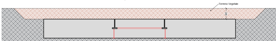
Sezione plinto torri da 2,0 MW dopo la demolizione
