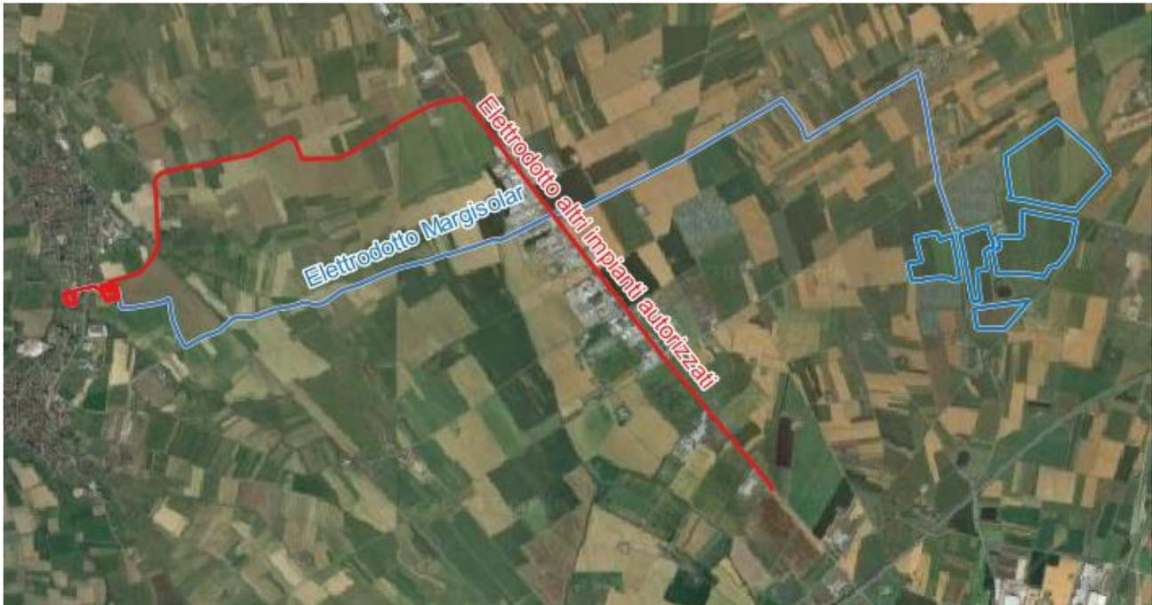
**In azzurro l'impianto e i cavidotto per cui si richiede l'autorizzazione, in rosso gli impianti e cavidotti esistenti o autorizzati**
