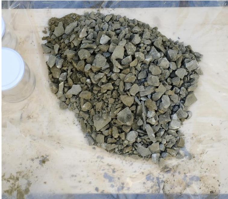
**Figura 29** – Riduzione granulometria degli incrementi prelevati a formare il campione medio-composito di materiale litoride.
