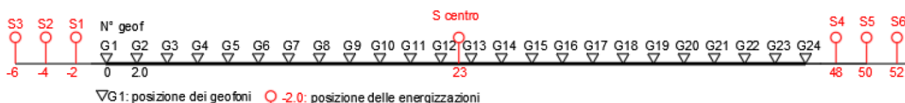
Figura 34 Schema geometrico di acquisizione dei dati per gli stendimenti di lunghezza L = 46,0 m
