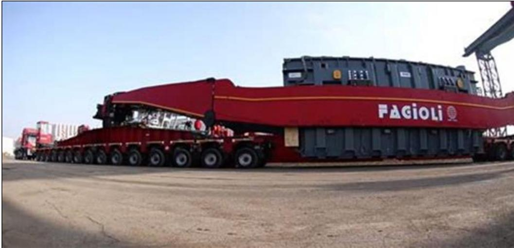
*Figura 7: Tipico convoglio con spalle e semirimorchi autolivellanti*
