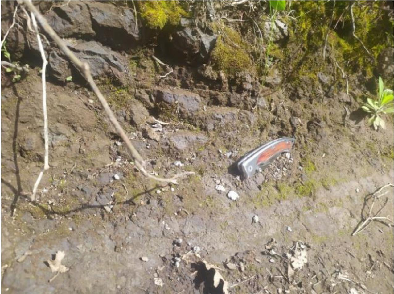
**Figura 5.15 - Profilo di alterazione dei Basalti della Subunità di Sindia lungo la strada di accesso alla WTG M1\_12. Coordinate 470307.92 m E-4448731.99 m N. l'alterazione chimica è piuttosto profonda e ha causato la perdita della consistenza litoide dell'orizzonte superficiale in affioramento, che risulta sostanzialmente friabile**
