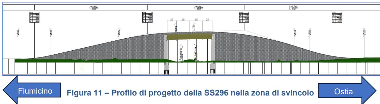
Rispetto alla viabilità attuale, che si sviluppa a piano campagna, le 2 rampe che permettono alla nuova viabilità di scavalcare la nuova rotatoria, hanno una pendenza intorno al 3% per permettere la realizzazione di opportuni raccordi parabolici che consentano il mantenimento della velocità di progetto e le opportune distanze di visibilità-
