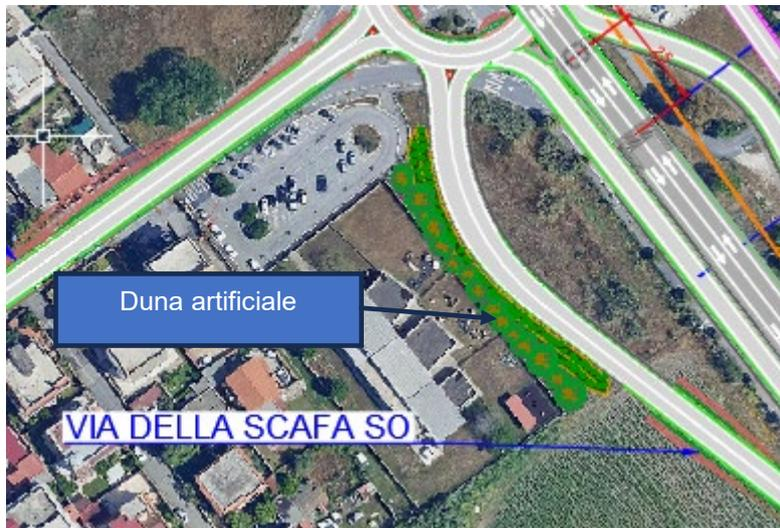
Figura 16 – Rilevato antirumore
