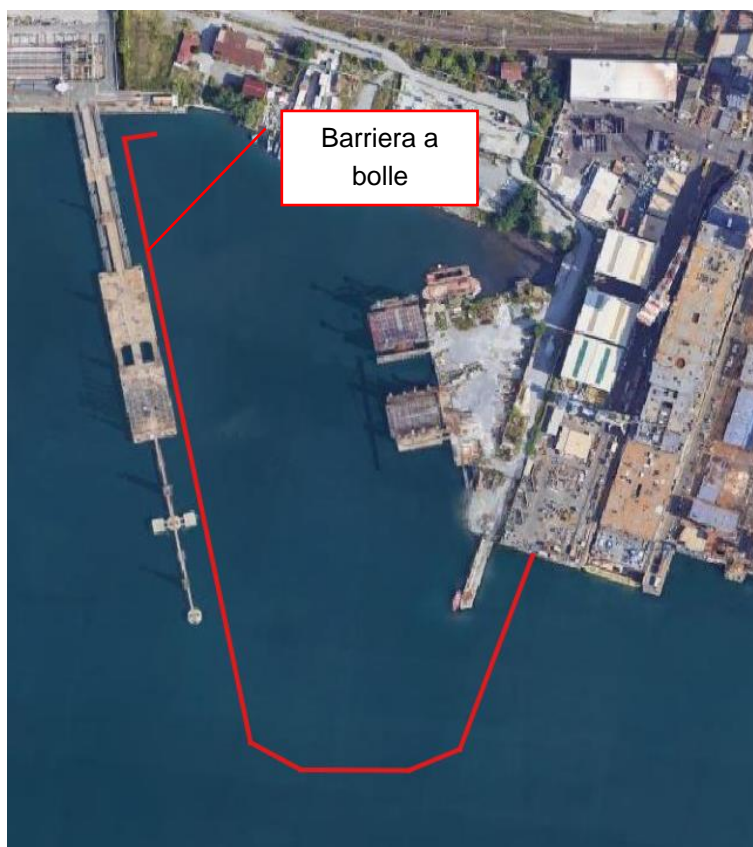
Figura 1-5 – Schema preliminare di posizionamento delle barriere anti torbidità
