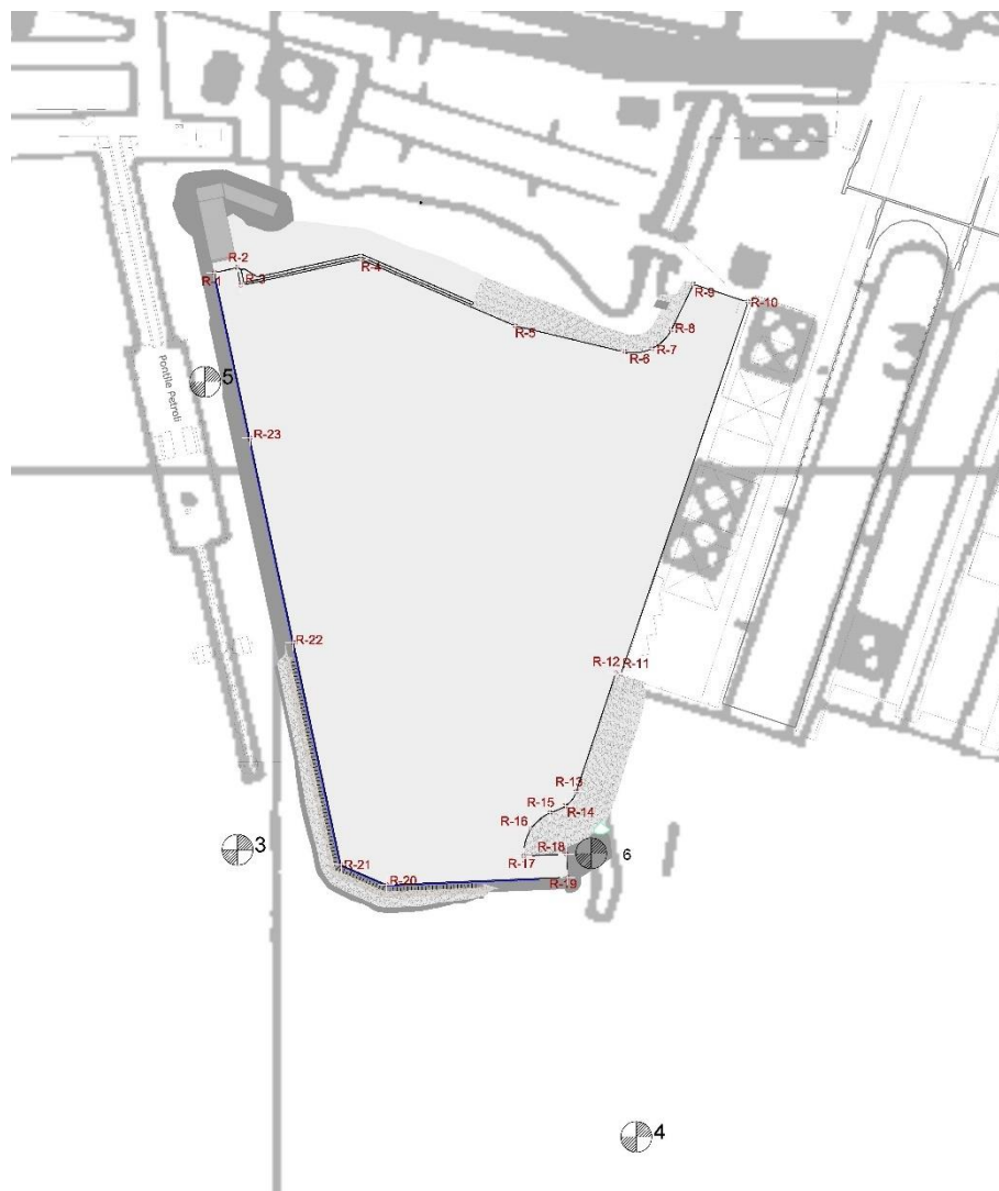
Figura 3-2 – posizionamento delle stazioni di monitoraggio ante operam rispetto all'impronta della futura colmata
