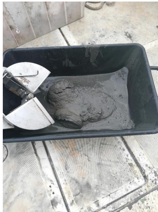
Figura 7: Campionamenti sedimenti tramite benna Van Veen
