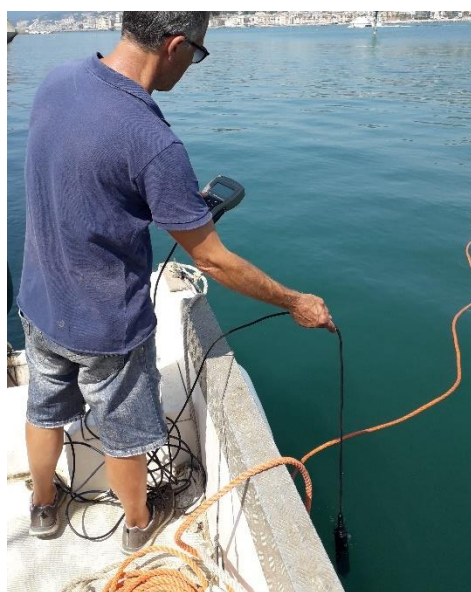
Figura 3: Operazioni di campionamento e misura con sonda multiparametrica
