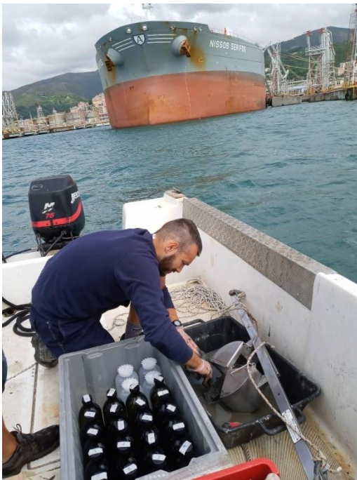
Figura 7: Campionamenti sedimenti tramite benna Van Veen
