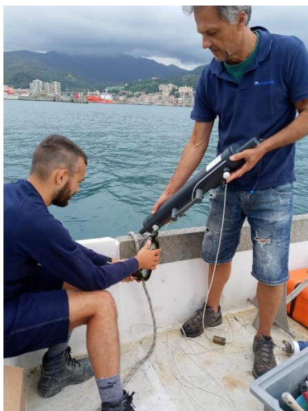
Figura 3: Operazioni di campionamento e misura con sonda multiparametrica
