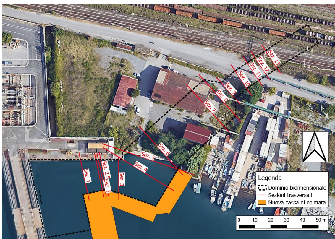
Figura 3.1 Dominio di calcolo bidimensionale (linea tratteggiata in nero), individuazione delle sezioni trasversali di progetto (linee rosse) e della nuova cassa di colmata (poligono arancione)
