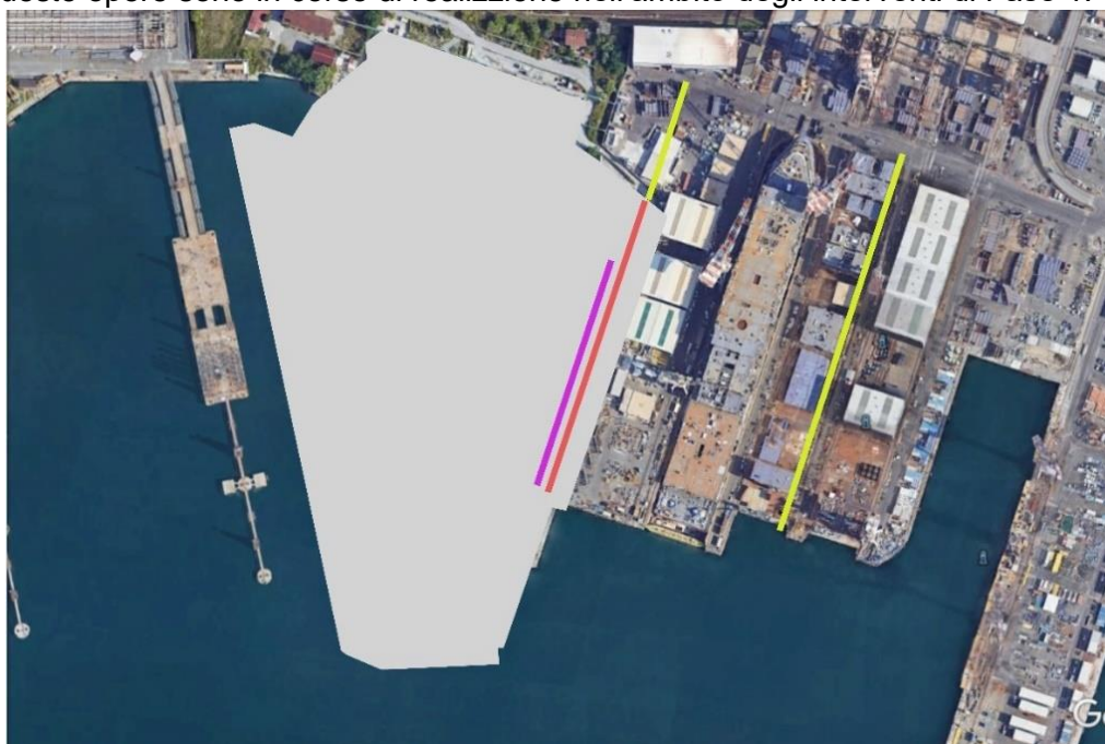
Figura 86: Posizione binari gru a cavalletto: in viola i binari della gru da 200ton, in rosso i binari della gru a cavalletto, in giallo i binari della gru a cavalletto: opere non incluse nel presente progetto di Fase 2
