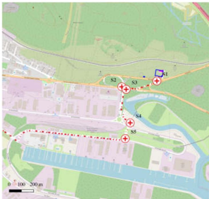
Fig. 2: posizionamento dei carotaggi lungo la nuova condotta in progetto
