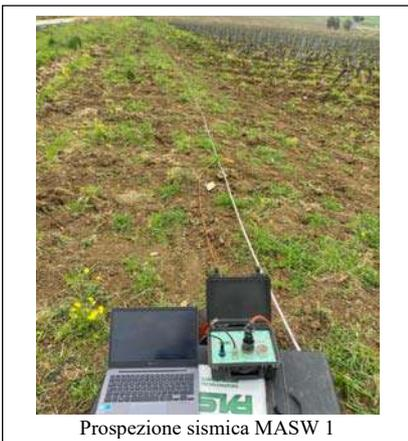
Prospezione sismica MASW 1
