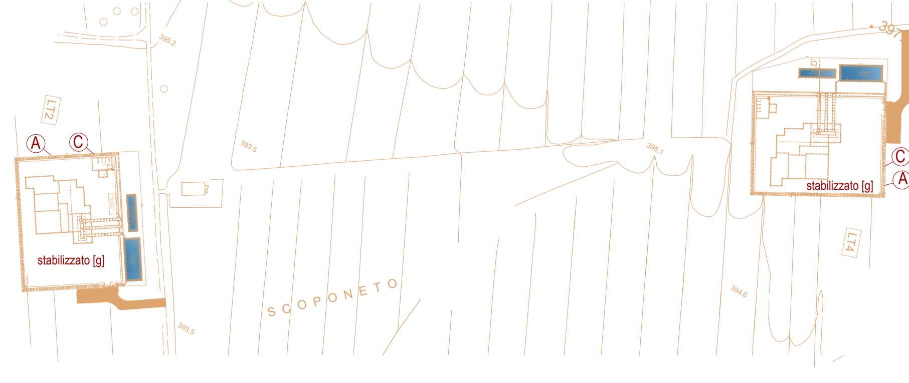
PLANIMETRIA POSTAZIONI LT2 E LT4 (di riserva): ipotesi di individuazione degli interventi (rif. abaco)
