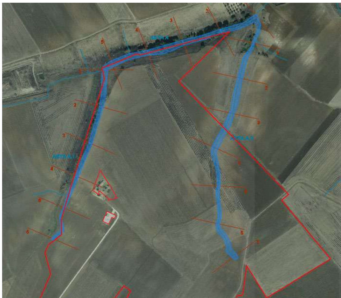
Figura 12 – Planimetria con indicazione delle aree inondabili duecentennali.
