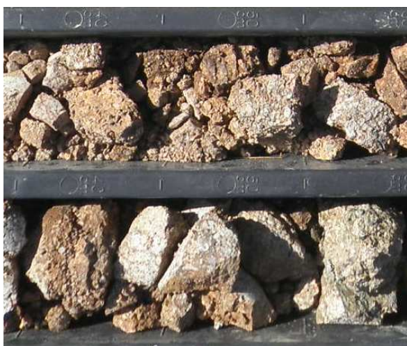
A sinistra, granitoida "arenizzato" estratto nel sondaggio a carotaggio continuo presso l'aerogeneratore L_12; si noti che la roccia semicoerente ha mantenuto le strutture originarie. A destra, si noti invece il comportamento allo scavo di tali materiali, che si presentano come sabbie grossolane e/o sabbie ghiaiose incoerenti.
