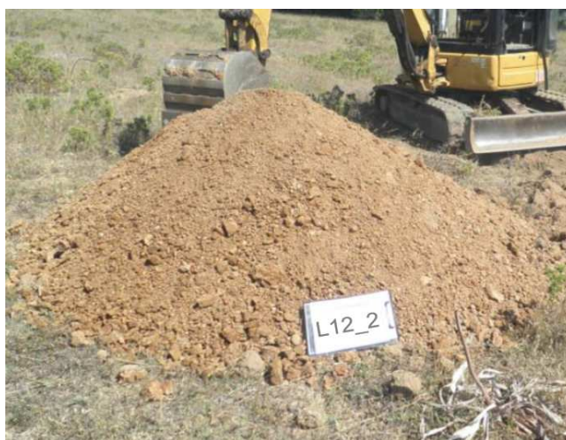
A sinistra, granitoida "arenizzato" estratto nel sondaggio a carotaggio continuo presso l'aerogeneratore L_12; si noti che la roccia semicoerente ha mantenuto le strutture originarie. A destra, si noti invece il comportamento allo scavo di tali materiali, che si presentano come sabbie grossolane e/o sabbie ghiaiose incoerenti.
