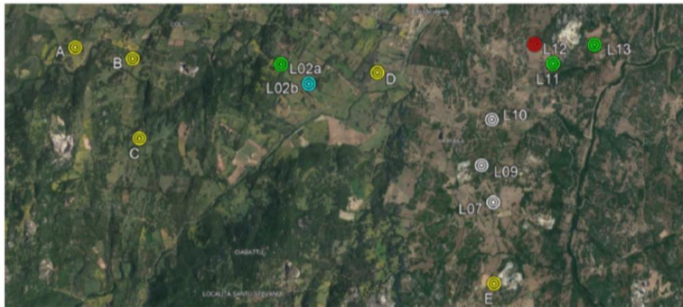
Ubicazione delle indagini eseguite. In rosso, sondaggio a carotaggio continuo, trincee esplorative e indagini sismiche eseguite in area accessibile, prossime o corrispondenti alla torre. In verde, trincee esplorative e indagini sismiche in aree accessibili, prossime o corrispondenti alla torre. In azzurro, indagini sismiche in aree accessibili, prossime alla torre. In bianco, indagini sismiche eseguite in prossimità delle previste aree di intervento, non ancora accessibili. In giallo, altre indagini sismiche eseguite.
