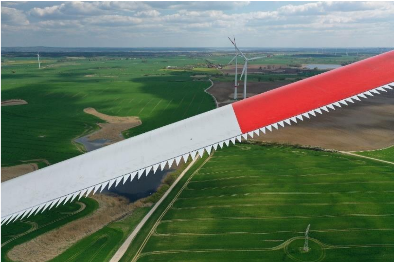
Figura 16. Dettaglio Pala Eolica Serrated Trailing Edge (STE)
