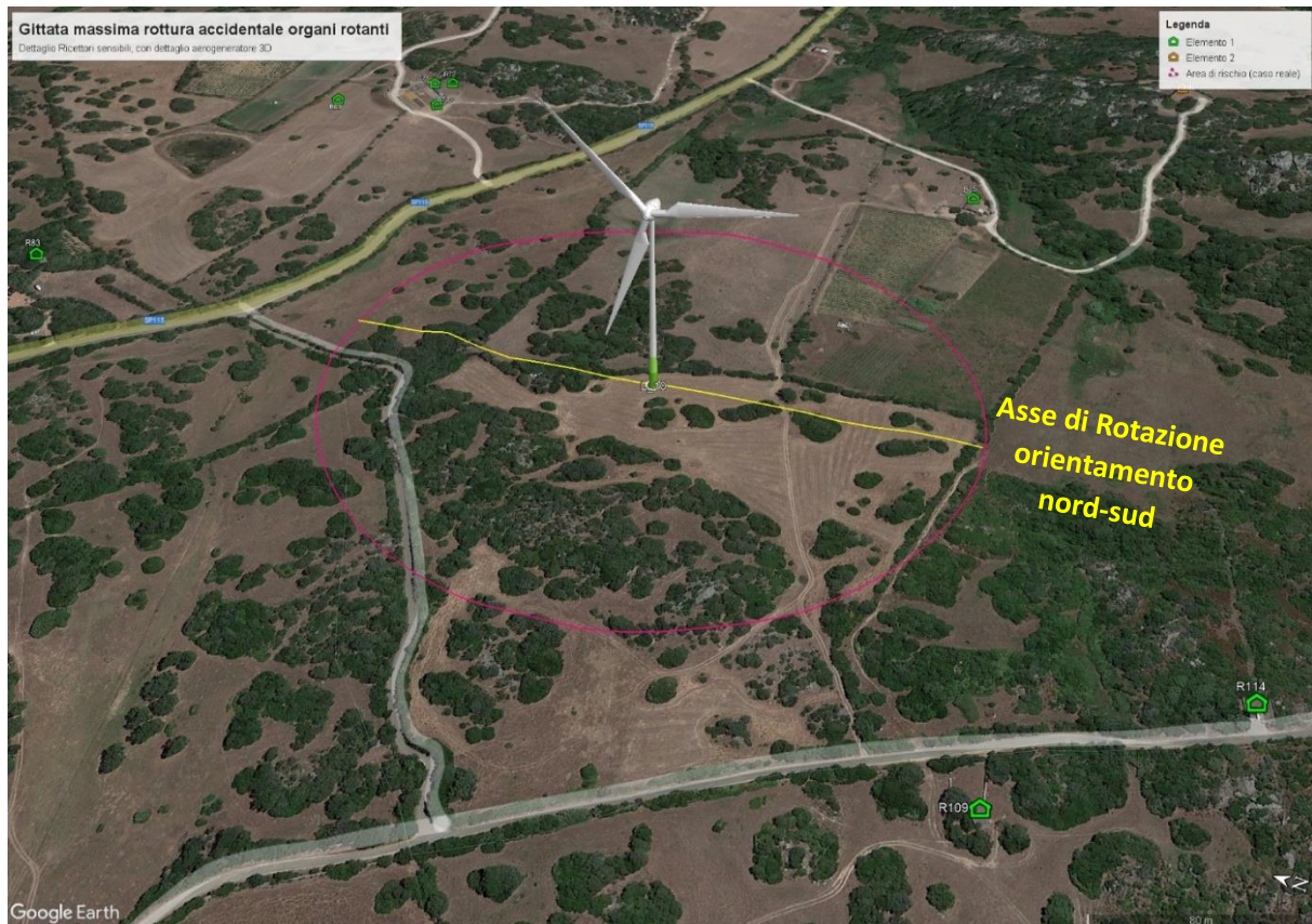
Figura 17. Dettaglio aerogeneratore L_10, con indicazione dell'asse di rotazione delle pale (Real Case)
