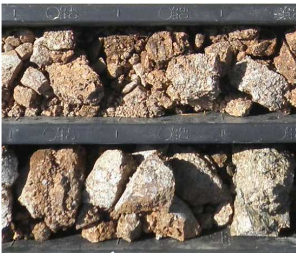
A sinistra, granitoide "arenizzato" estratto nel sondaggio a carotaggio continuo presso l'aerogeneratore L_12; si noti che la roccia semicoerente ha mantenuto le strutture originarie. A destra, si noti invece il comportamento allo scavo di tali materiali, che si presentano come sabbie grossolane e/o sabbie ghiaiose incoerenti.
