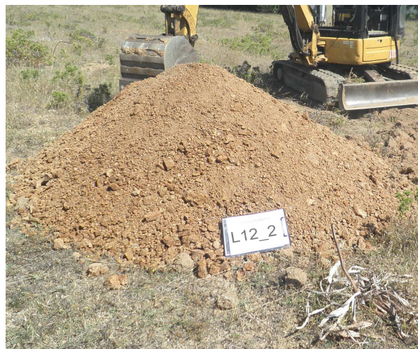
A sinistra, granitoide "arenizzato" estratto nel sondaggio a carotaggio continuo presso l'aerogeneratore L_12; si noti che la roccia semicoerente ha mantenuto le strutture originarie. A destra, si noti invece il comportamento allo scavo di tali materiali, che si presentano come sabbie grossolane e/o sabbie ghiaiose incoerenti.
