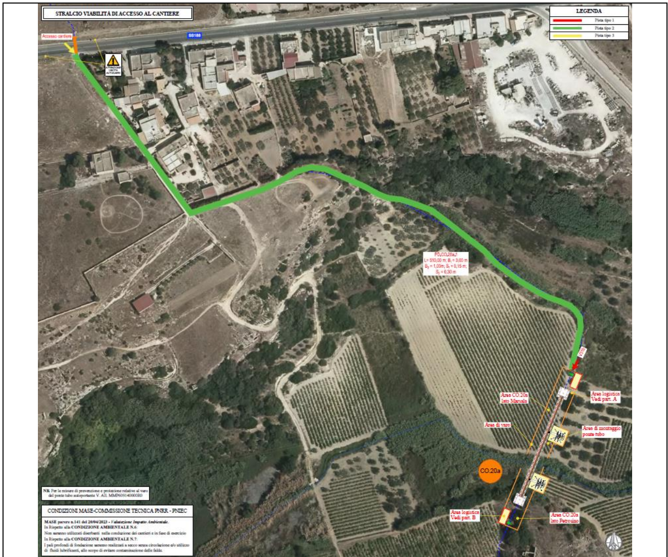
Foto satellitare con panoramica della viabilità di accesso alle aree del Cantiere Operativo In verde è evidenziata la pista in terra battuta esistente da ampliare in affiancamento
