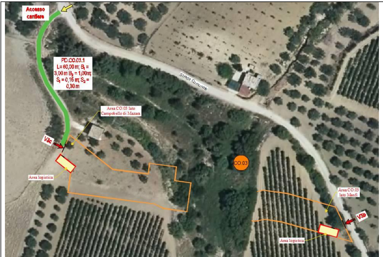
Foto satellitare con panoramica della viabilità di accesso alle aree del Cantiere Operativo CO.03. In verde è evidenziata la pista di cantiere da realizzarsi su stradella esistente in terra battuta, da ampliare in affiancamento (v. Tav. 6.9.2)
