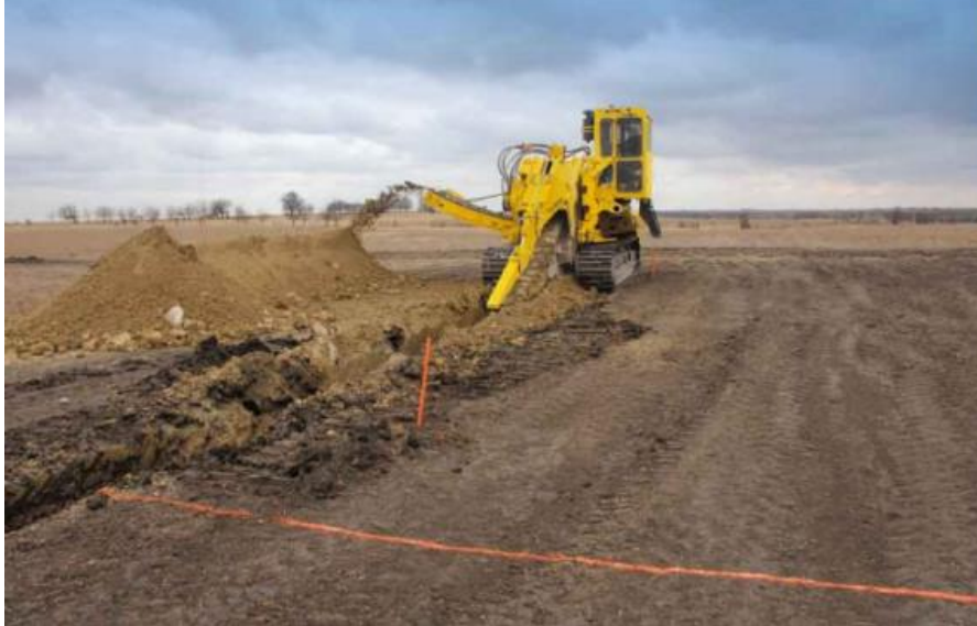
Fig. 5: esempio di trencher
