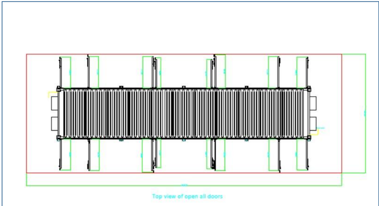
FIGURA 22: CABINATO PER STORAGE (BESS) VISTA DALL'ALTO
