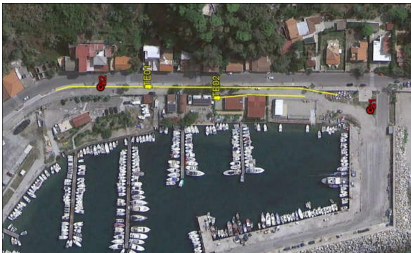
Figura 5.5 - Piano delle indagini geoelettriche integrative (Tomografia elettrica TE01 e TE02)
