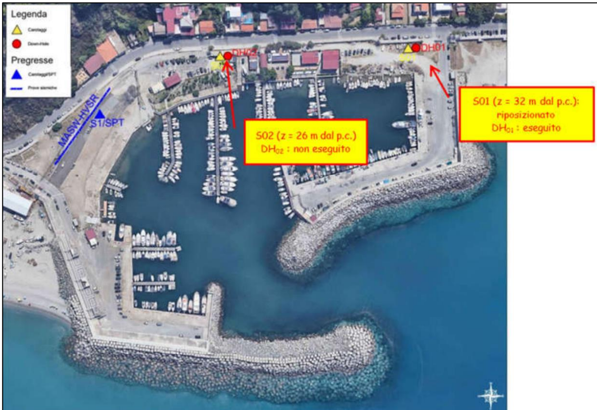
Figura 5.3 - Piano delle indagini geognostiche eseguite
