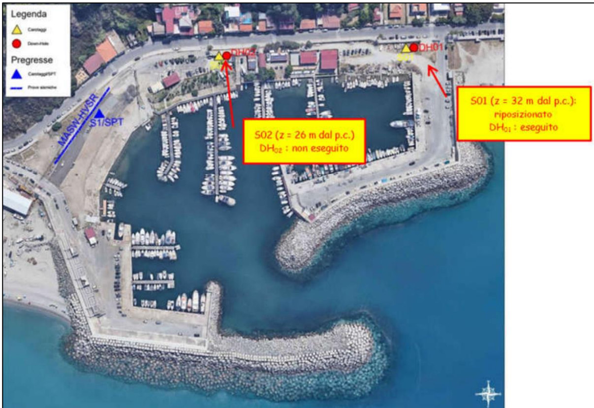
Figura 2.1 - Piano delle indagini geognostiche eseguite
