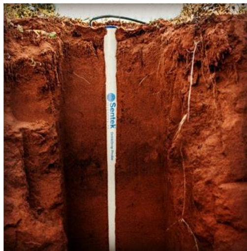
Figura 2: Sonda Multilivello Sentek (Fonte: elaborato tecnico "Il risparmio idrico legato all'alta efficienza della microrrigazione nei sistemi agrivoltaici" di Netafim Italia srl)
