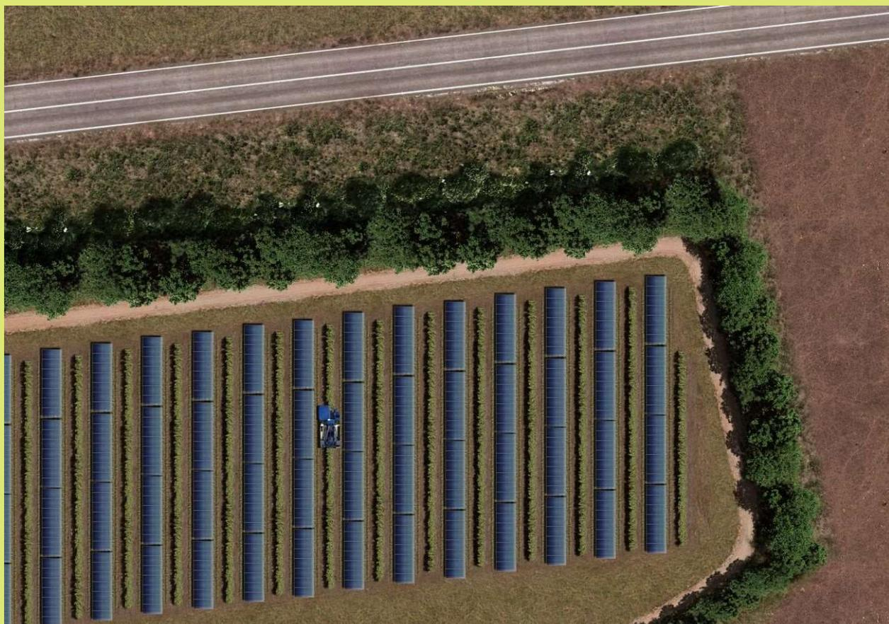
Figura 31. ZOOM E. Stato di progetto, con fasce di mitigazione, tracker e oliveto a siepe consociato alle colture erbacee.
