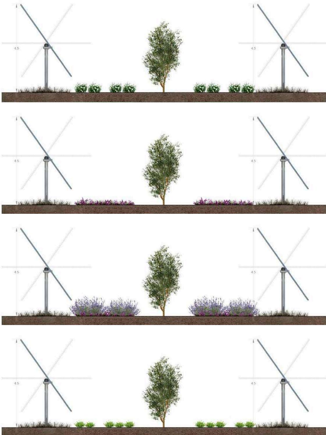
*Figura 24 \_ Sezioni tipo del progetto agrivoltaico con alternanza pannelli fotovoltaici/coltivazione (ulivo più seminativo a pireto, ulivo più seminativo a foraggera "Sulla", ulivo più seminativo a lavanda, ulivo più seminativo a timo)*
