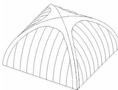
Figura 11. Schema di una volta a padiglione, nota localmente come volta "a carrozza".
