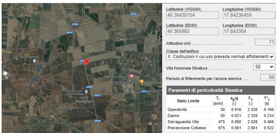
Secondo le Norme Tecniche per le Costruzioni del D.M. 17.01.2018 (NTC 18), all. A, l'azione sismica sulle costruzioni è valutata a partire dalla pericolosità di base, che costituisce l'elemento di conoscenza primario per la determinazione delle azioni sismiche.
