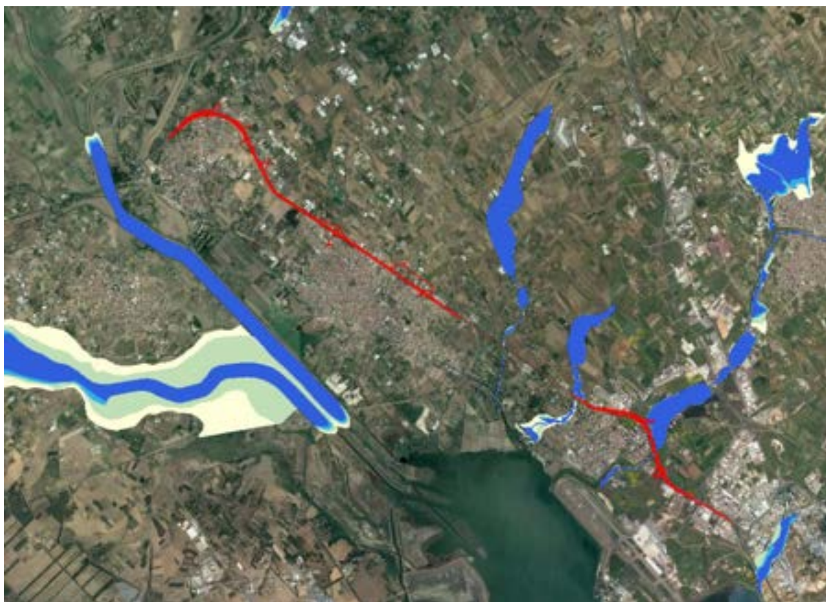
Figura 2-19 Aree a pericolosità idraulica (Fonte: Geoportale Sardegna). In rosso il tracciato di progetto
