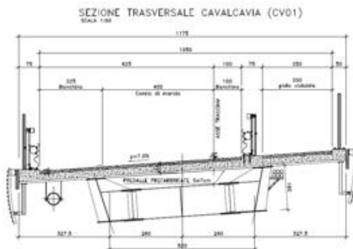
Figura 4.9. Sezione trasversale impalcato
