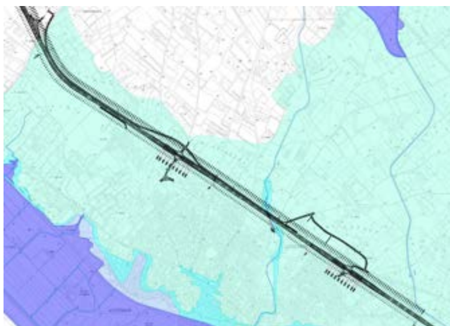
Figura 5-19 Estratto cartografico in cui si evidenzia come nel territorio in cui ricade il progetto siano individuate nel PAI aree a pericolosità/rischio idraulico (Elmas)
