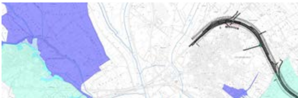
Figura 5-21 - Estratto cartografico in cui si evidenzia come nel territorio in cui ricade il progetto siano individuate nel PAI aree a pericolosità/rischio idraulico (Decimomannu)
