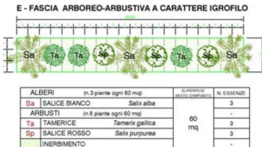
Figura 7-12 Sesto di impianto Tipologico E
