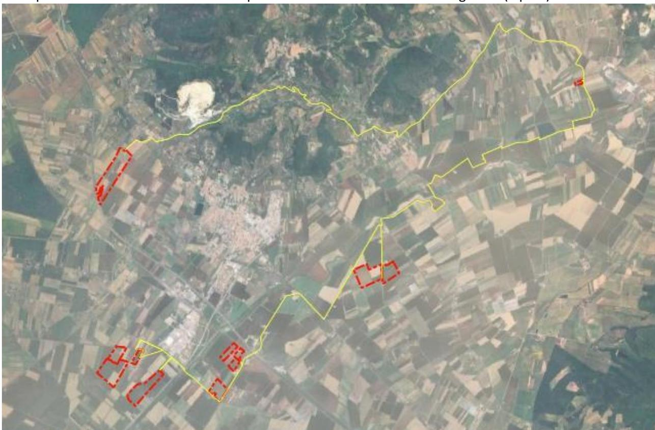
FIGURA 7 – ELETTRODOTTO DI COLLEGAMENTO IN GIALLO ED AREE DI IMPIANTO IN ROSSO SU ORTOFOTO
