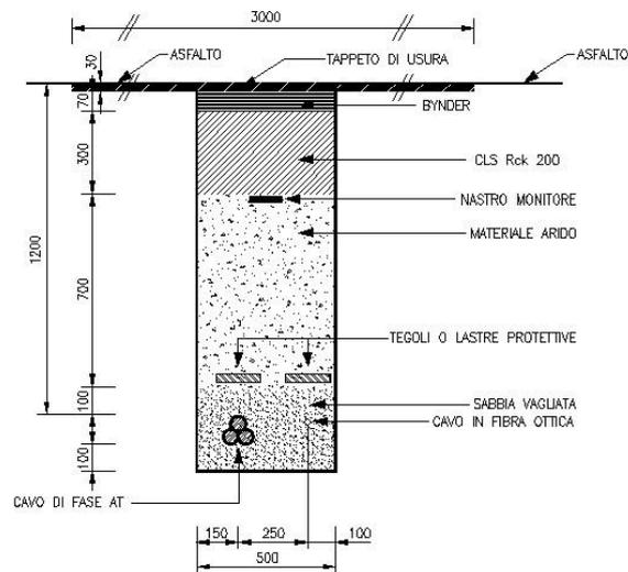
**Figura 3:** *Tipici di posa cavi AT con n°1 e linee su viabilità asfaltata*
