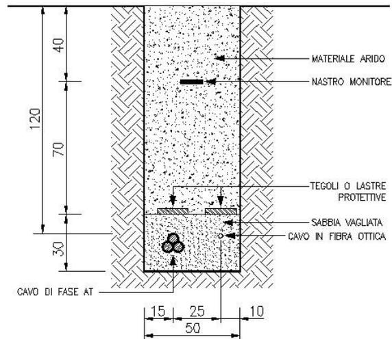
**Figura 2:** *Tipici di posa cavi AT con n°1 linee su terreno vegetale*
