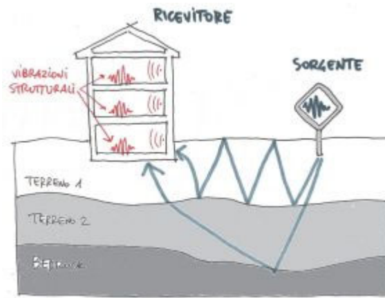
Figura 5 – Schematizzazione semplificata della propagazione delle vibrazioni nel sistema terreno-edificio
