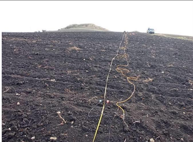
**BS03 e MASW 03, particolare della strumentazione**
