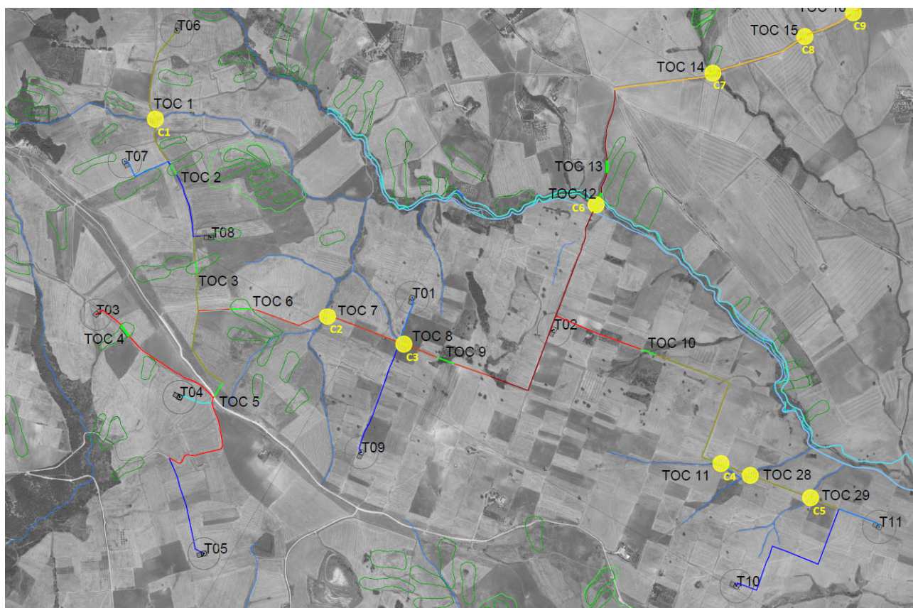
Attraversamento reticolo idrografico mediante posa in TOC – Interferenze da C1 a C7
