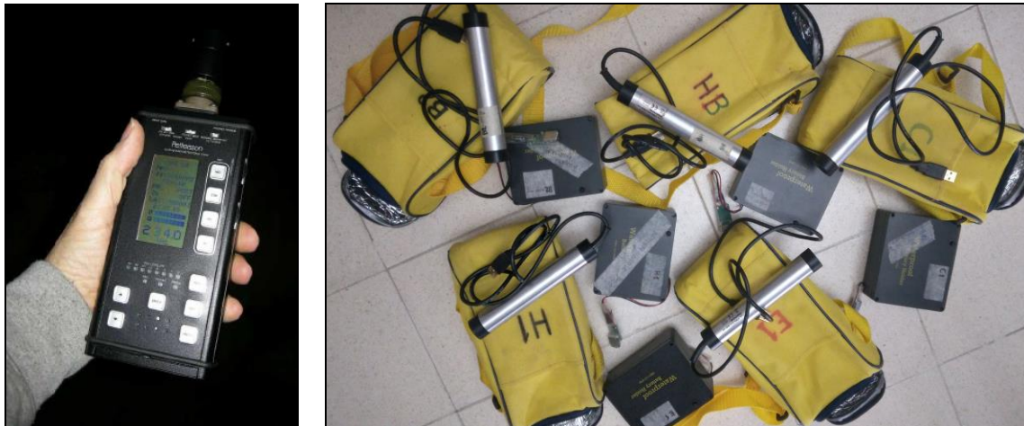
Figura 11. I bat detector utilizzati nel monitoraggio preliminare dei Mammiferi Chiroterri: a sinistra il bat detector multifunzione D1000x Pettersson 1000; a destra i 5 microfoni audio-ultrasonici Ultramic 384K di Dodotronic. Entrambi registrano i contatti ultrasonici full spectrum con una massima frequenza di 384 kHz e su file wav della durata impostata per le analisi su 5 secondi (su una scheda di memoria interna). L'autonomia degli Ultramic 384K – con power bank di 3 pile D- può arrivare a sette notti consecutive, con registrazione su 8-9 ore per notte.
