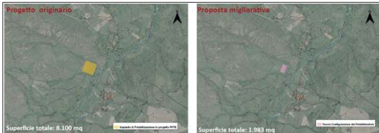
Figura 1: Ubicazione Potabilizzatore con superficie di intervento ridotto.
