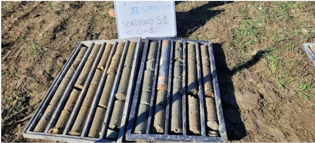
Foto n.3 -Carotaggio sondaggio S1: da 0 a 10m, da dx verso sx
