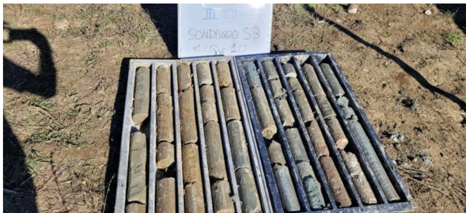
Foto n.9 -Carotaggio sondaggio S3: da 0 a 10m, da dx verso sx
