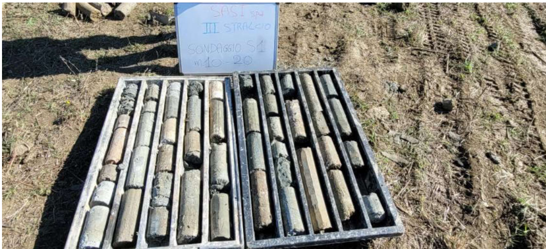
Foto n.4 -Carotaggio sondaggio S1: da 10 a 20m, da dx verso sx
