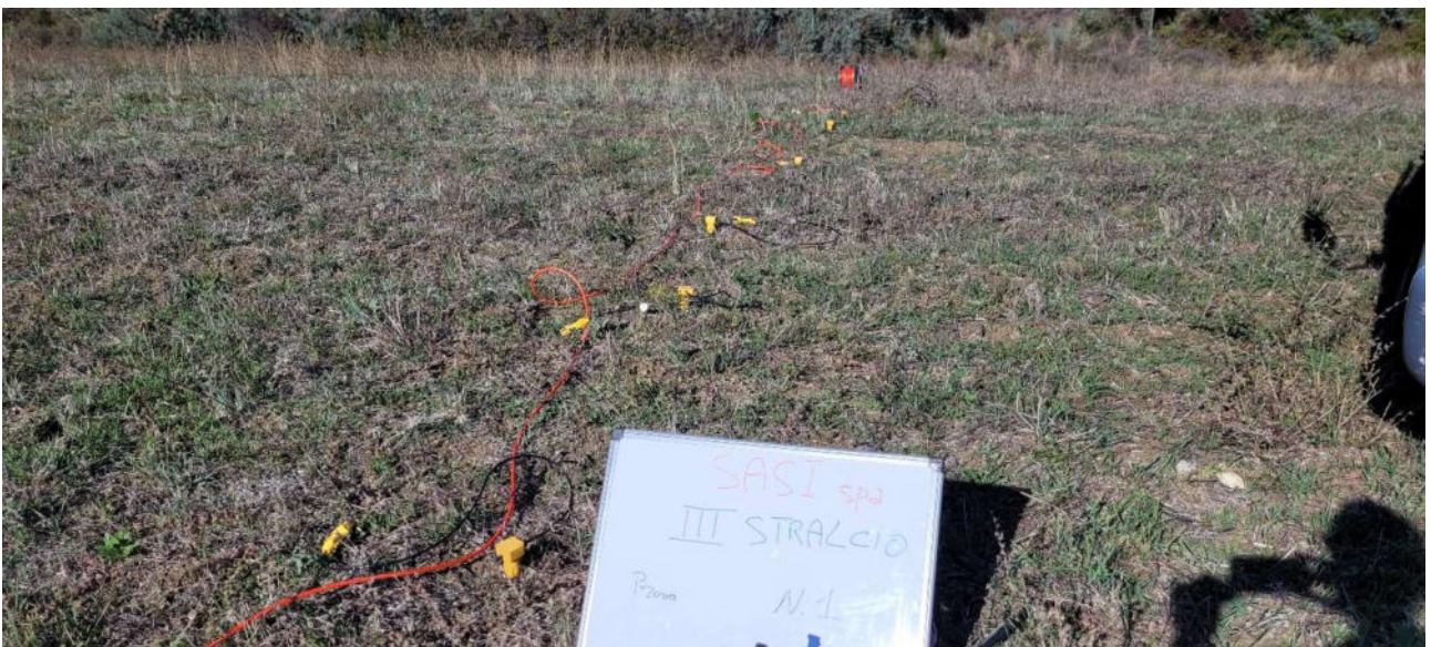
Foto n°1-2: Strumentazione utilizzata per indagine sismica del tipo Masw. Stendimento sismico con 12 geofoni verticali e sistema d'acquisizione sismografo PASI GEA24
