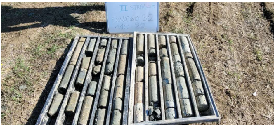
Foto n.7 -Carotaggio sondaggio S2: da 10 a 20m, da sx verso dx
