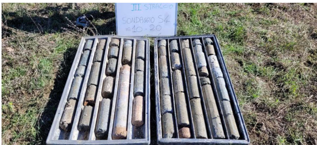
Foto n.13 -Carotaggio sondaggio S4: da 10 a 20m, da dx verso sx
