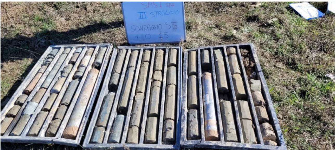
Foto n.2 -Carotaggio sondaggio S5: da 0 a 15m, da dx verso sx
