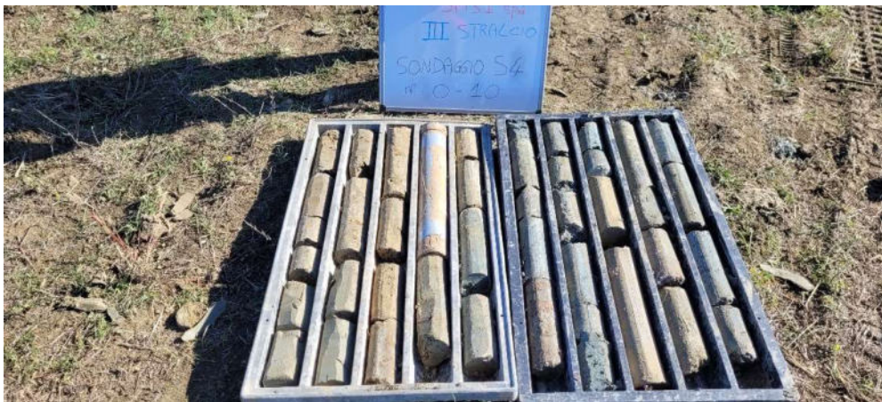
Foto n.12 -Carotaggio sondaggio S4: da 0 a 10m, da dx verso sx
