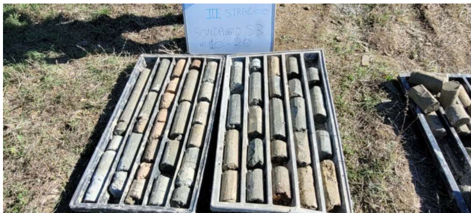
Foto n.10 -Carotaggio sondaggio S3: da 10 a 20m, da dx verso sx
