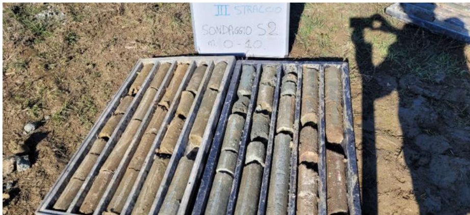
Foto n.6 -Carotaggio sondaggio S2: da 0 a 10m, da sx verso dx
