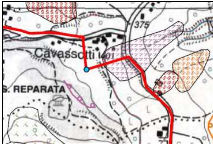
Figura 7: Tracciato dell’acquedotto (in rosso) e vasca di disconnessione nel pallino azzurro ,nello scenario geomorfologico locale - Stralcio dalla carta geomorfologica del PAI
