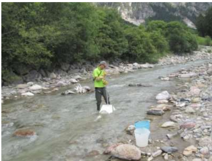
Figura 1: Esempio di campionamento di macroinvertebrati fluviali mediante cattura con retino tipo Surber.
