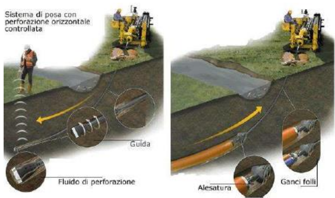
Posa in opera tubazione con trivellazione teleguidata
