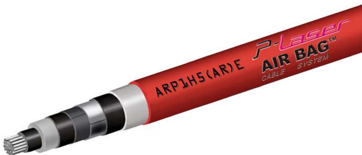
Particolare degli strati costitutivi del cavo MT ARP1H5(AR)E 18/30 kV
