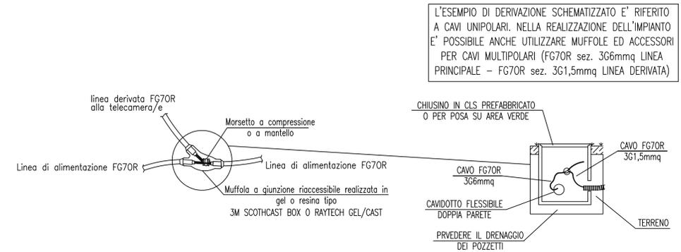
L'ESEMPIO DI DERIVAZIONE SCHEMATIZZATO E' RIFERITO A CAVI UNIPOLARI. NELLA REALIZZAZIONE DELL'IMPIANTO E' POSSIBILE ANCHE UTILIZZARE MUFFOLE ED ACCESSORI PER CAVI MULTIPOLARI (FG70R sez. 3G6mmq LINEA PRINCIPALE - FG70R sez. 3G1,5mmq LINEA DERIVATA)
