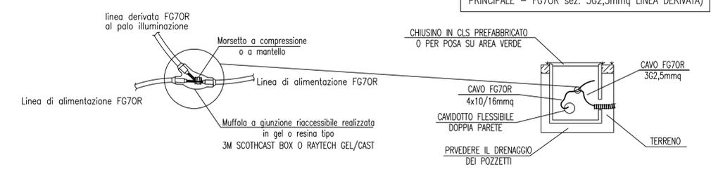
L'ESEMPIO DI DERIVAZIONE SCHEMATIZZATO E' RIFERITO A CAVI UNIPOLARI. NELLA REALIZZAZIONE DELL'IMPIANTO E' POSSIBILE ANCHE UTILIZZARE MUFFOLE ED ACCESSORI PER CAVI MULTIPOLARI (FG70R sez. 4x10/16mmq LINEA PRINCIPALE - FG70R sez. 3G2,5mmq LINEA DERIVATA)
