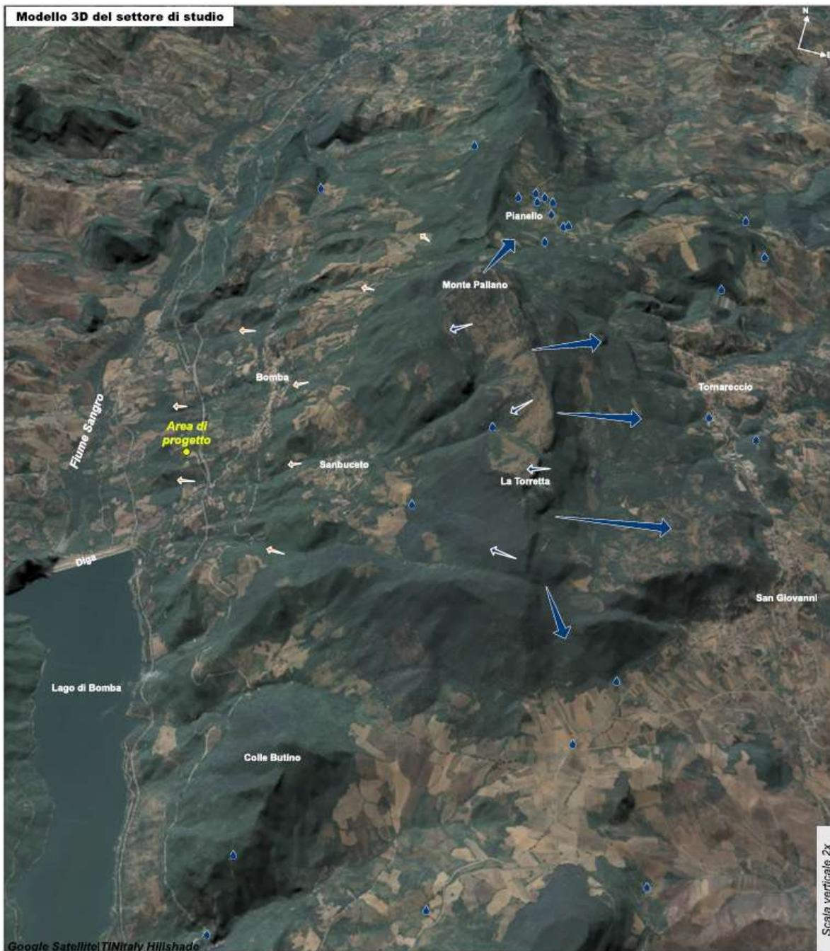
**FIGURA 3-4: MODELLO 3D DEL SETTORE DI STUDIO DI MONTE PALLANO CON INDICAZIONE DELLE SORGENTI (GOCCE BLU) E DELLE PRINCIPALI DIREZIONI DI DEFLUSSO IDRICO SOTTERRANEO NEL SUBSTRATO (FRECCE BLU) E NEI DEPOSITI DI COPERTURA (FRECCE ARANCIO). LA GRANDEZZA DELLE FRECCHE È DIRETTAMENTE PROPORZIONALE ALL’INTENSITÀ DEL FLUSSO.**
