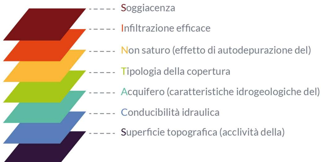
**FIGURA 5-1: SCHEMA DELLA SOVRAPPOSIZIONE DEI DIVERSI PARAMETRI CONSIDERATI NEL METODO SINTACS PER IL CALCOLO DELLA VULNERABILITÀ DELL'ACQUIFERO.**
