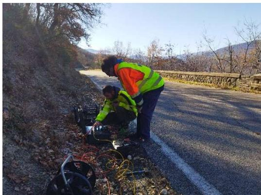
FIGURA 2-7: ACQUISIZIONE GEOELETTRICA – E.R.T. 2D.
