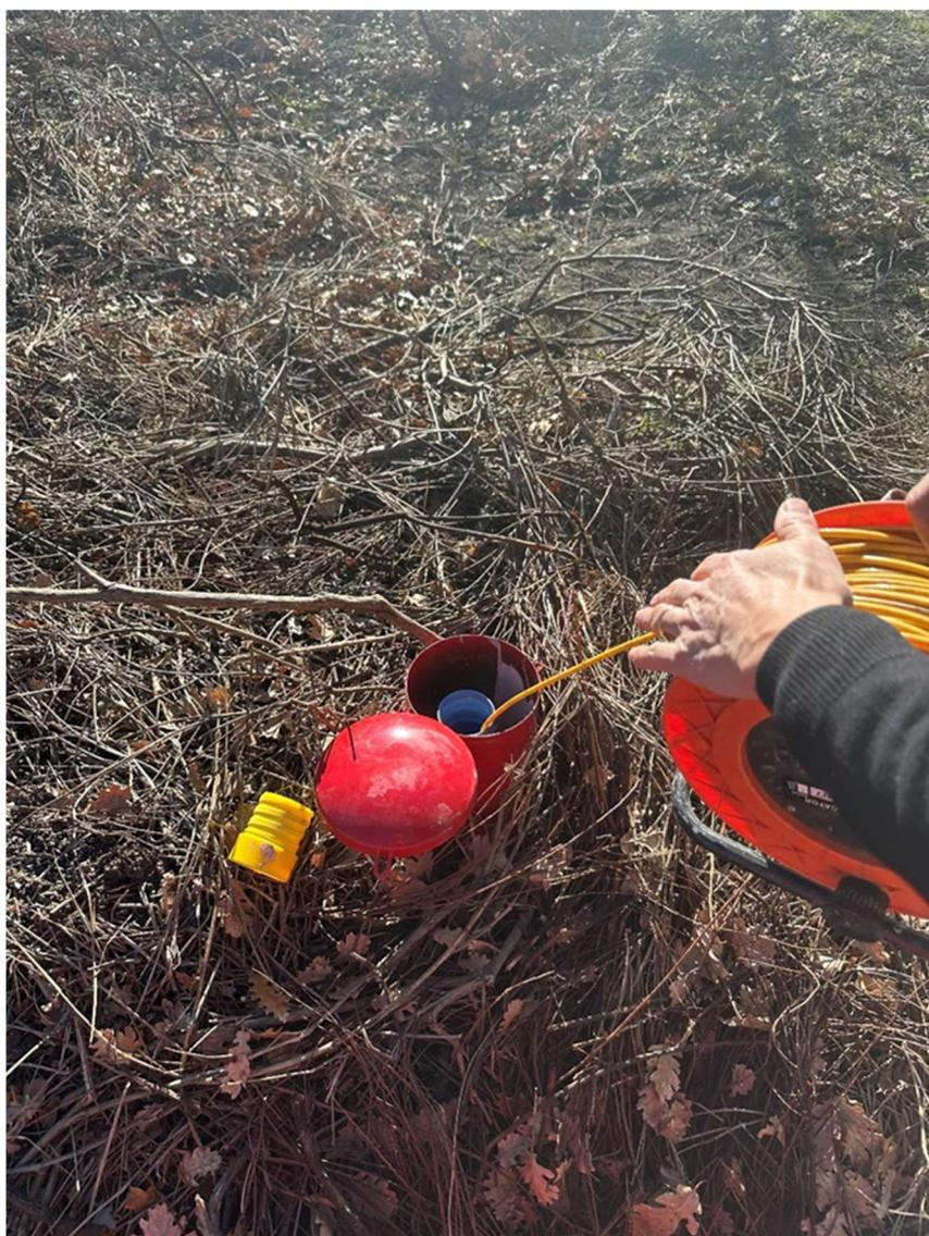
**FIGURA 2-22: FOTO DELLA MISURAZIONE ESEGUITA A GENNAIO 2024 DEL LIVELLO PIEZOMETRICO ALL'INTERNO DEL FORO DI SONDAGGIO S1 (CAMPAGNA INDAGINI 2023).**
