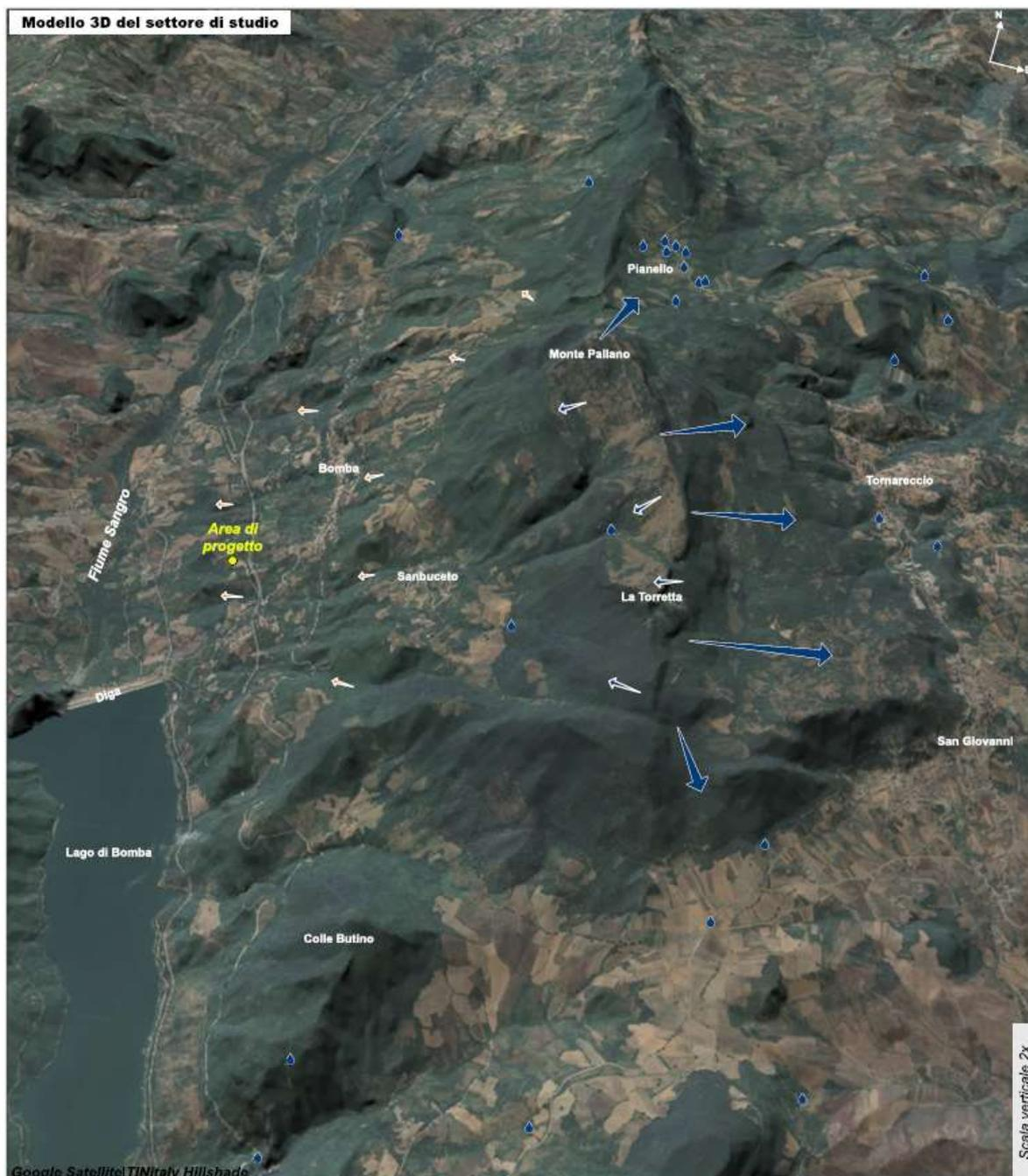
FIGURA 2-Z: MODELLO 3D DEL SETTORE DI STUDIO DI MONTE PALLANO CON INDICAZIONE DELLE SORGENTI (GOCCE BLU) E DELLE PRINCIPALI DIREZIONI DI DEFLUSSO IDRICO SOTTERRANEO NEL SUBSTRATO (FRECCHE BLU) E NEI DEPOSITI DI COPERTURA (FRECCHE ARANCIO). LA GRANDEZZA DELLE FRECCHE È DIRETTAMENTE PROPORZIONALE ALL’INTENSITÀ DEL FLUSSO
