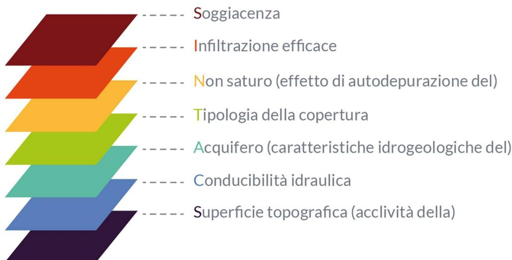
**FIGURA 2-CC: SCHEMA DELLA SOVRAPPOSIZIONE DEI DIVERSI PARAMETRI CONSIDERATI NEL METODO SINTACS PER IL CALCOLO DELLA VULNERABILITÀ DELL'ACQUIFERO**
