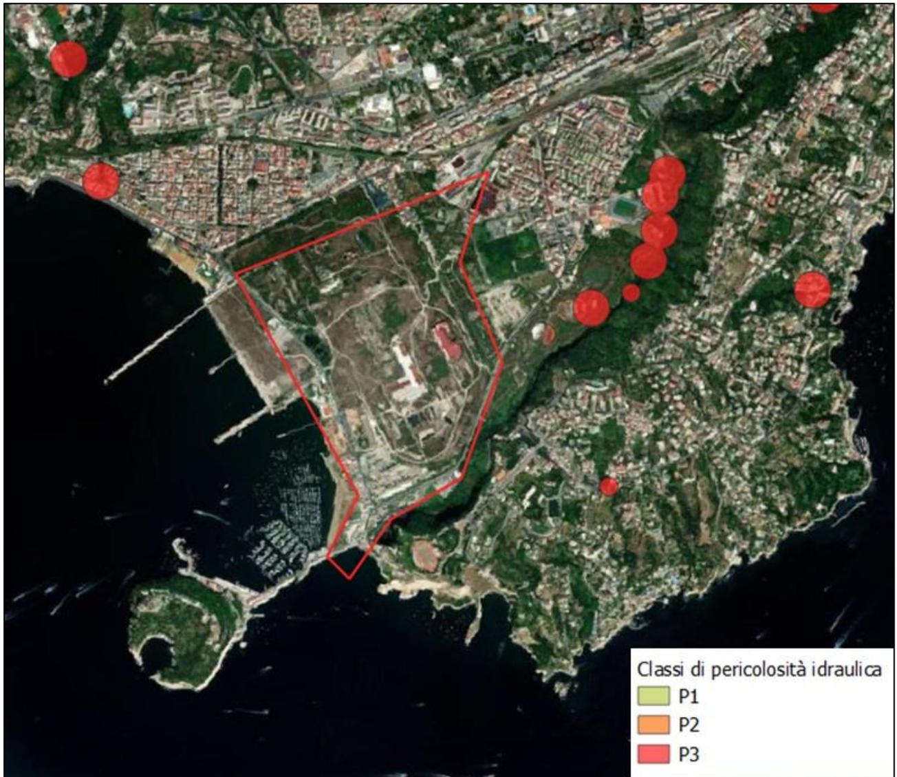
Figura 4-6: Stralcio Carta della Pericolosità idraulica - PSAI
