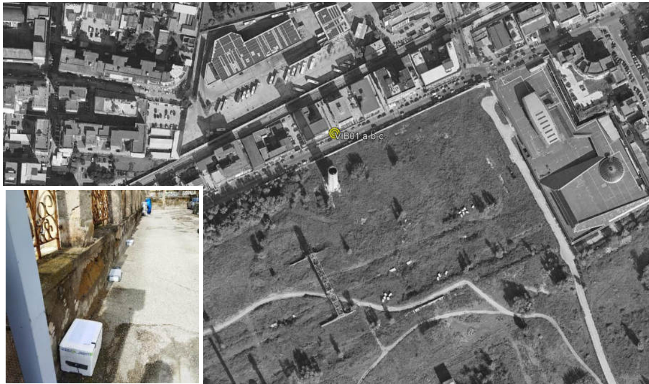
Figura 8-57 Planimetria della postazione di installazione della strumentazione di misura per la caratterizzazione della sorgente traffico nella sezione a raso (nel riquadro il dettaglio del transetto VIB.01-a-b-c)
