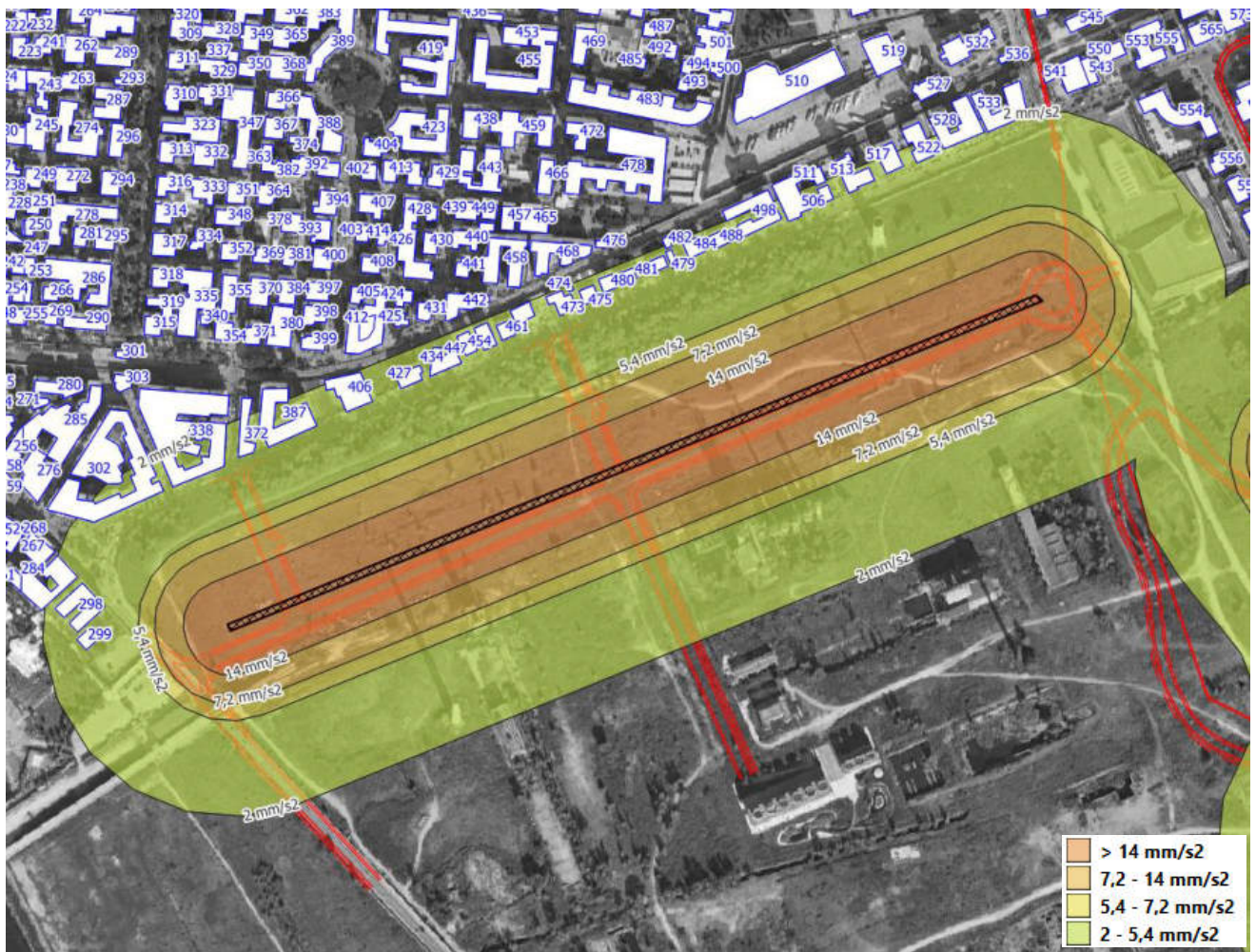
Figura 8-67 – Ampiezza propagazione delle vibrazioni – stralcio area di lavoro con isolivello delle vibrazioni con scala rispetto ai valori limite indicati dalla UNI 9614:2017.
