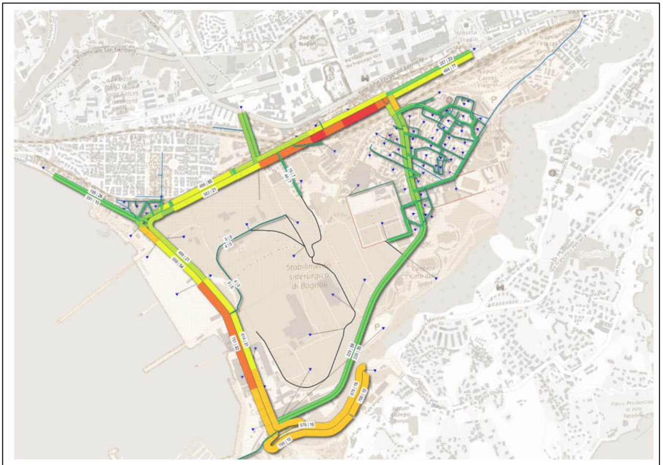
Figura 8-176: Flussogramma saturazione allo stato attuale
