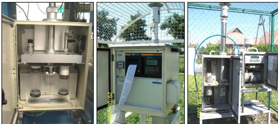
Nel caso in cui si facesse utilizzo di strumentazione priva di campionatore sequenziale con deposito filtri, è cura dell'esecutore del monitoraggio provvedere manualmente alla sostituzione dei filtri (che dovrà necessariamente avvenire alle ore 24.00).
