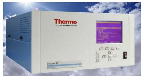
13/08/2010 e s.m.i. [UNI EN 14212:2005 "Qualità dell'aria ambiente. Metodo normalizzato per la misurazione della concentrazione di diossido di zolfo mediante fluorescenza ultravioletta"].
