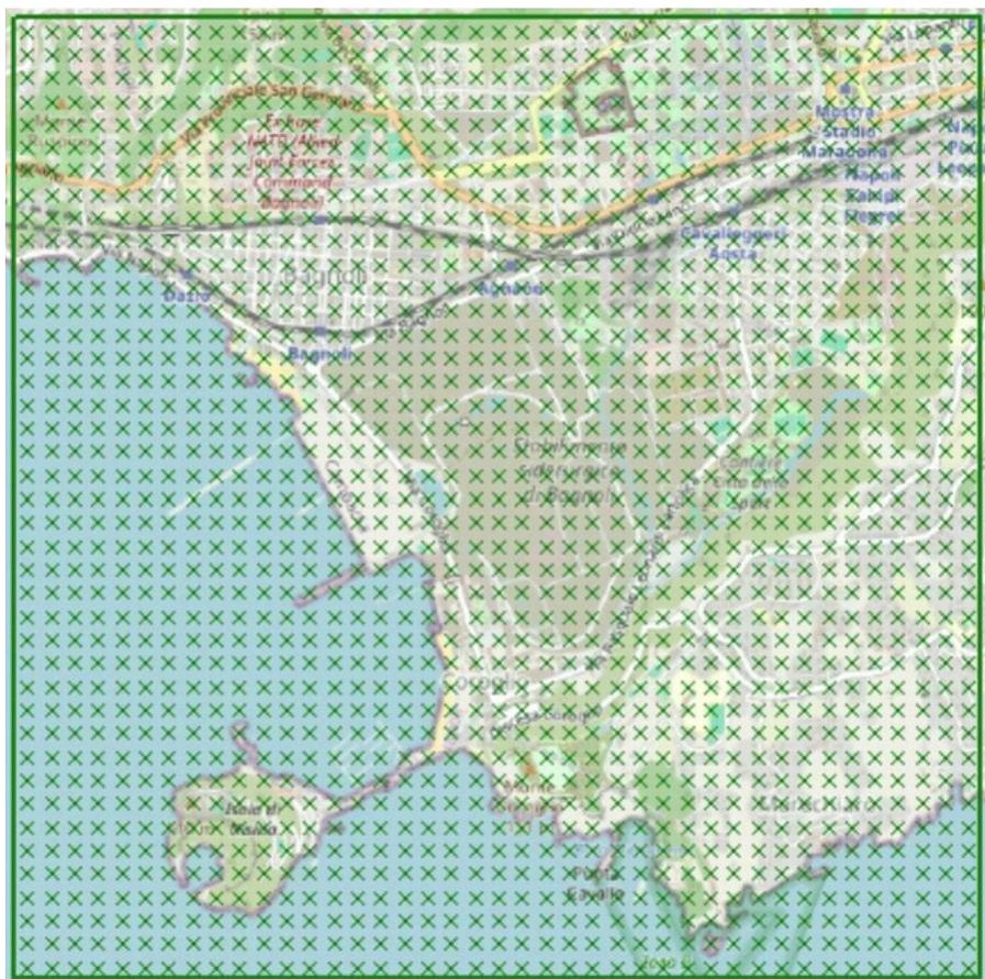
Figura 5—4 Griglia di calcolo per la dispersione degli odori con passo cella di 100 metri
