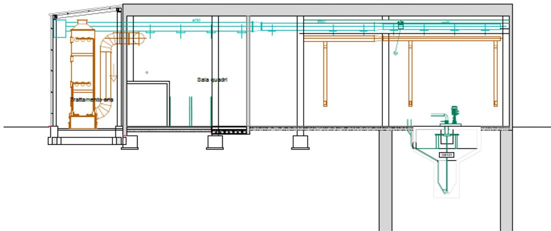
Figura 5—3 Sezione impianto pretrattamento con dettaglio linea trattamento aria ed espulsione camino E2
